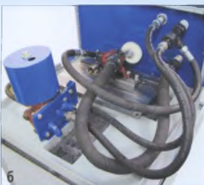
Рис. 2. Расположение агрегатов масляной системы дизелей при испытании на стенде КИ-28256.01 ГОСНИТИ (защитный кожух стенда снят): а) ЯМЗ-236; б) Д-243
