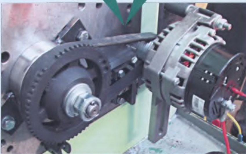
Рис. 3. Диагностирование генератора на стенде КИ-28256.01 с применением комплекта КИ-28246 ГОСНИТИ
