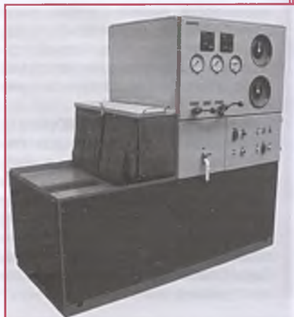
Рис. 1. Общий вид стенда КИ-28256.01 ГОСНИТИ для испытания насосов и фильтров системы смазки автотракторных дизелей
