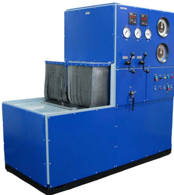
Рисунок 1 – Общий вид стенда КИ-28256.01 ГОСНИТИ для испытания насосов и фильтров системы смазки автотракторных дизелей.
