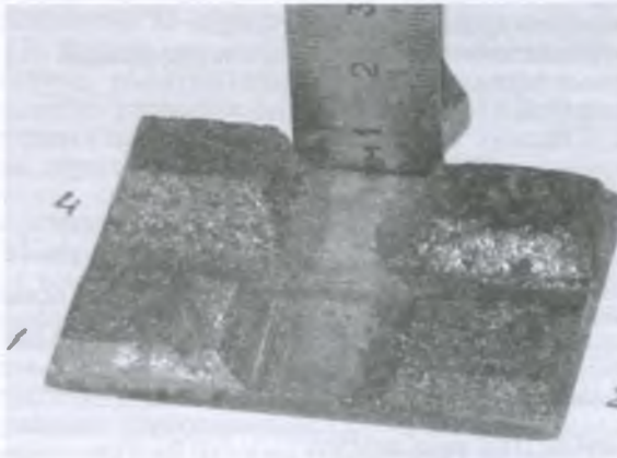
Рис. 2. Примеры толстослойных покрытий повышенной сплошности: 1 – бронза БрКМц 3-1 – толщина 4,5 мм; 2 – никром (Х20Н80) – 4,7 мм; 3 – сталь 65Г – 5,7 мм; 4 – никром (4,7 мм) + БрКМц 3-1 (+2,4 мм) + никром (+3,1 мм) + Т15К6 (+0,1 мм) – 10,3 мм. Обра-зец (основа) – сталь 10 толщиной 3 мм.
