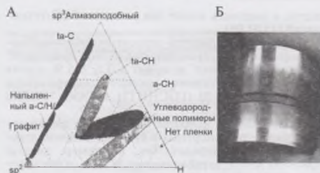
Рис. 3. а - трехфазная диаграмма областей содержания углерода и водорода для образования sp^2 и sp^3 -типовых гибридных углерода; б - гидрокомпенсатор ГРМ дизеля с алмазо-графитной пленкой (фото С.А.Сокол). Микротвердость на трущейся поверхности по В.В.Острикову повысилась с 1220...1280 до 1840...1870 кгс/см 2 .
