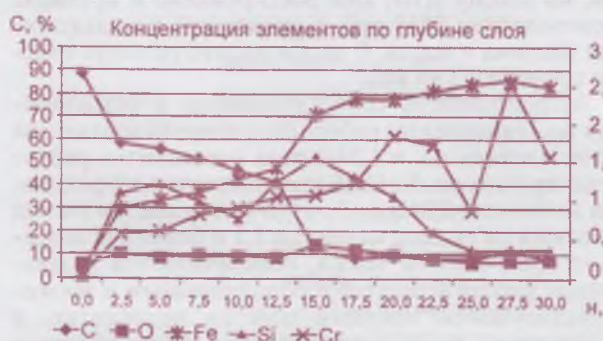
Рис. 4. Содержание химических элементов в РВС-слое по данным НППК "СУПРОТЕК".
