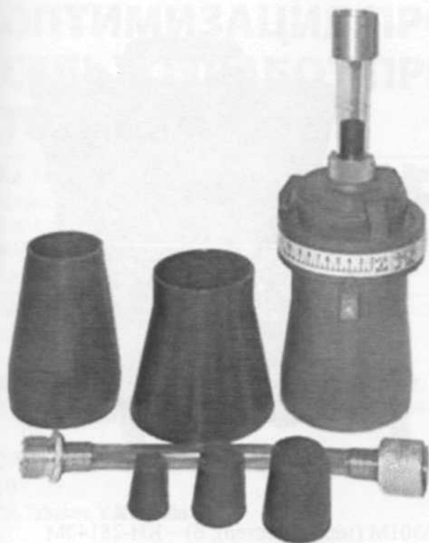
Рис. 2. Индикатор расхода картерных газов КИ-17999М
